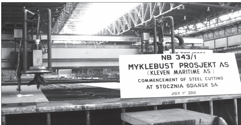
Cięciem blach rozpoczęto budowę kadłuba trawlera.
